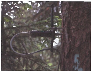
Der Punktdendrometer misst kontinuierlich die Stammradiusänderungen mit Mikrometerauflösung. Die Daten liefern Informationen zum Wachstum und zum Wasserhaushalt von Bäumen.
