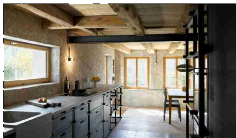
Die nachhaltige Küche «Ater Culina» in Volketswil (ZH) kommt praktisch ohne Schrauben, Leim und Scharniere aus. Die Oberflächen sind mit Russ behandelt.
